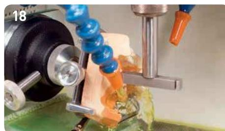
18 Il processo di elettroerosione è partito con il lavaggio del liquido dielettrico.
