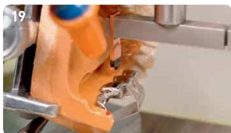
19 Il processo di elettroerosione si intende concluso una volta raggiunta la profondità nominale, durata dell'erosione circa 20 minuti (CoCrMo).
